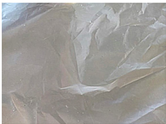
Пленка PLA/PBAT УФ облученная до компостирования
