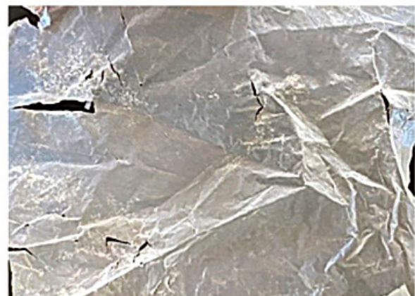
Пленка PLA/PBAT УФ облученная после 120 дней компостирования
