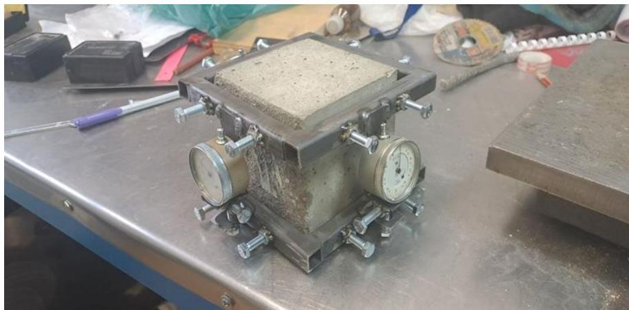
**Рис. 1.** Стальная траверса для закрепления индикаторов часового типа на бетонном образце
