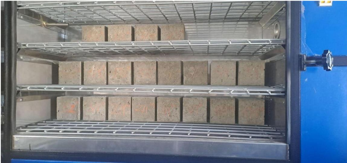
**Рис. 2.** Образцы в камере нормального твердения
