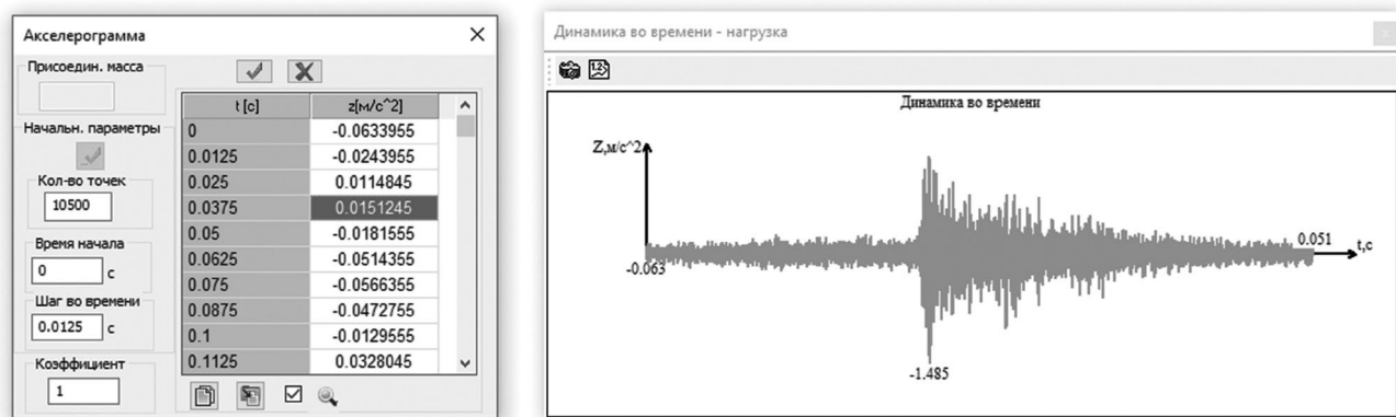
Рис. 2. Моделирование сейсмической нагрузки в виде акселерограммы Fig. 2. Simulation of seismic load in the form of an accelerogram
