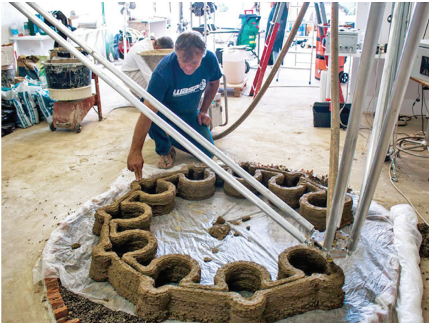
Рис. 5. Принтер с дельта-приводом Fig. 5. Delta construction printer
