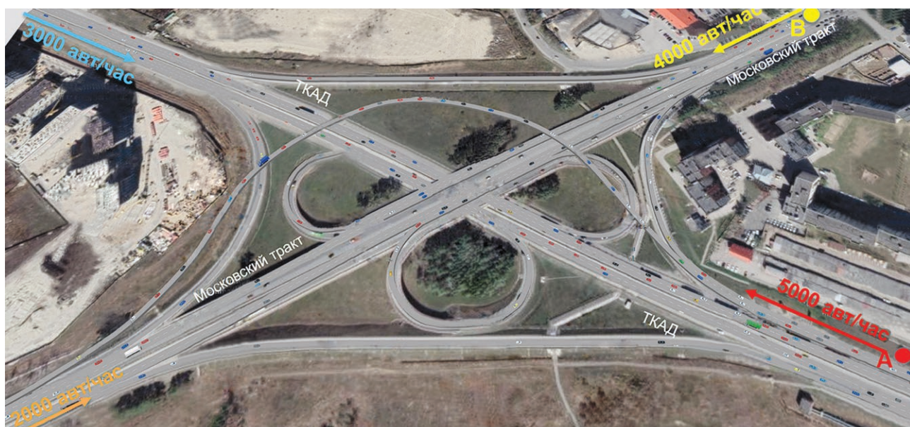
Рис. 9. Моделирование левоповоротного съезда на развязке Московский тракт – ТКАД в программном пакете VISSIM
