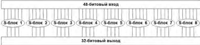
Рис. 1. Схема криптографического преобразования информации с помощью S-блоков в алгоритме DES
