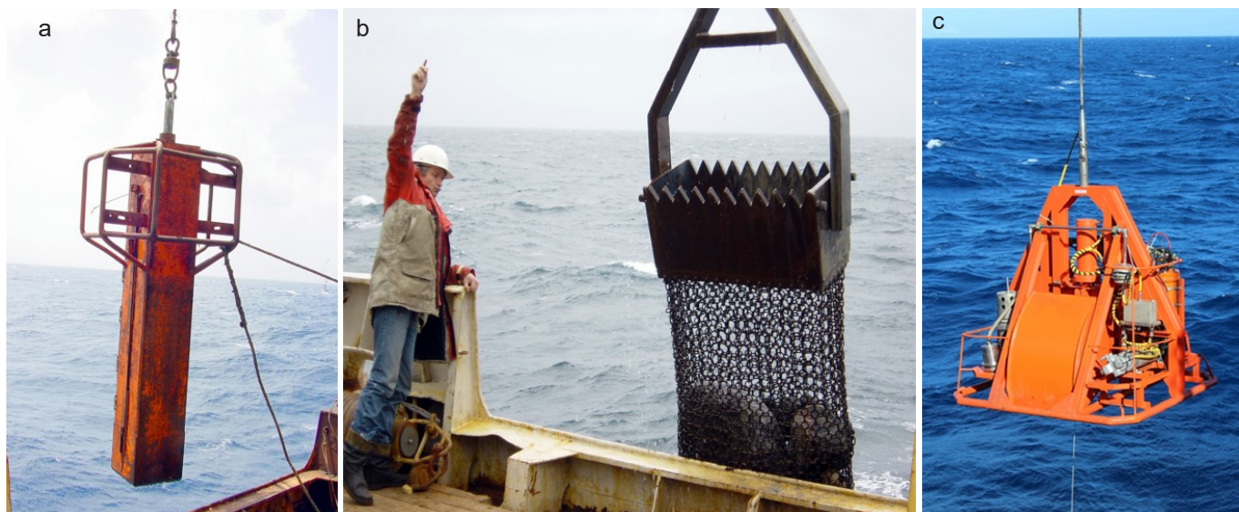
Рис. 2. Аппаратура для подъёма вещества со дна: а — коробчатый пробоотборник; б — скальная драга; с — грейфер с видеокamerой
