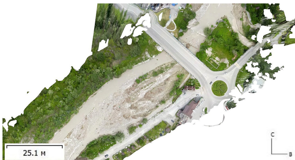
Рис. 3. Наносы в русле р. Нальчик на территории, прилегающей к автодорожному мосту
