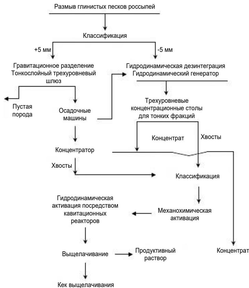
Рис. 4. Технологическая схема переработки высокоглинистых россыпей с использованием гидродинамических генераторов и кавитационных реакторов стационарного типа Fig. 4. Flow diagram of high clay placer processing using hydrodynamic generators and stationary cavitation reactors
