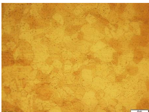
Рис. 4. Микроструктура латуни марки Л63, исходный образец (увеличение 400х) Fig. 4. Microstructure of CW508L brass, initial sample (400x magnification)
