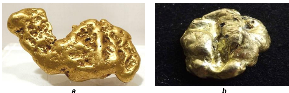
Рис. 2. Сравнение внешнего вида природного золотого самородка (а) и его имитации из расплавленной латуни, отлитой в холодную воду (б) Fig. 2. Comparison of the natural gold nugget (a) and its brass simulant obtained by casting in cold water (b)
