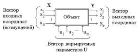
Рис. 3. Схема представления объекта для разработки ИНС-модели
