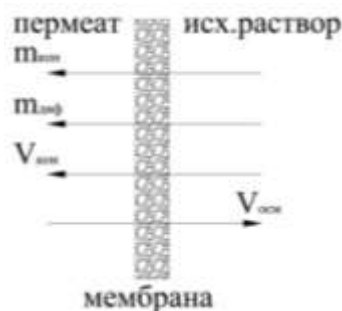
Рис. 2. Схема основных потоков вещества при ультрафильтрации
