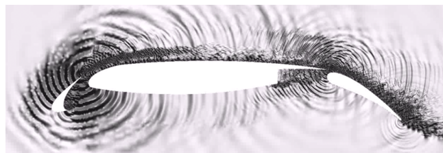
Рис 2. Акустическое поле вблизи профиля 30P30N.
