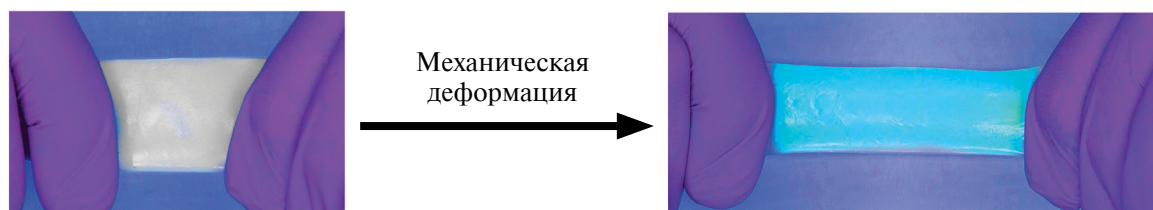
Рис. 4. Изменение цвета пленки ЖК-композиата полиуретана, содержащего дисперсию капель смеси холестерических жидких кристаллов, при растяжении.
