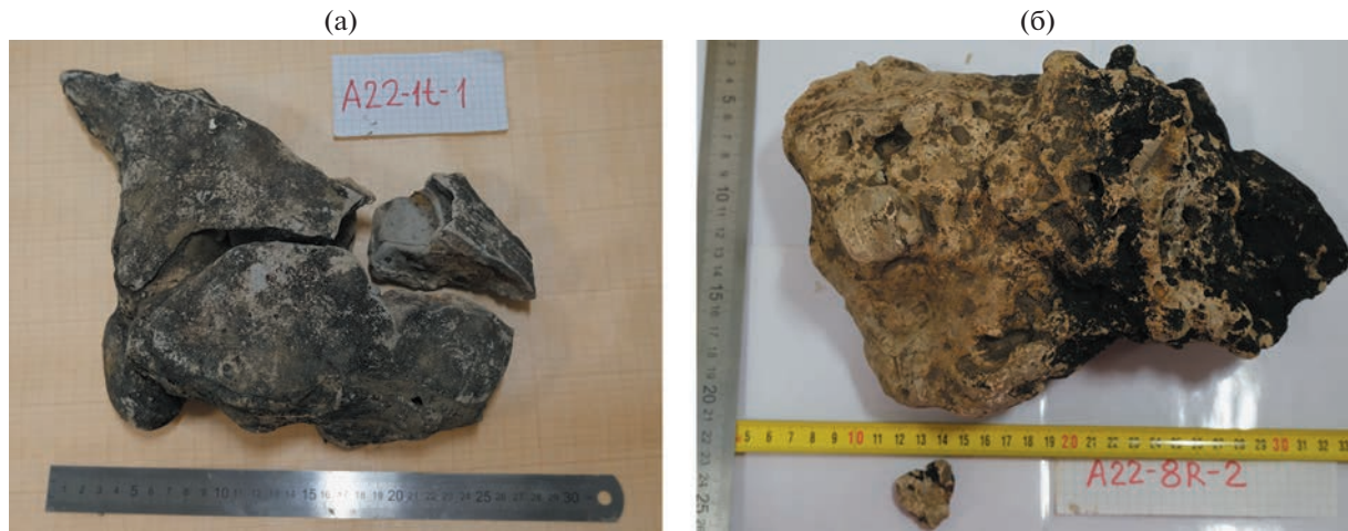
Рис. 2. Аутигенные карбонатные образования хребта Гаккеля: а — обр. A22-1t-1, магнизиальный кальцит; б — обр. A22-8R-2, арагонит.
