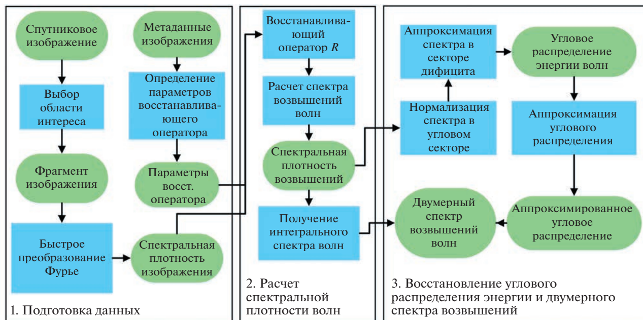
Рис. 1. Блок-схема метода дистанционного измерения углового распределения энергии по двумерным пространственным спектрам ветровых волн, восстанавливаемых по спектрам спутниковых изображений.
