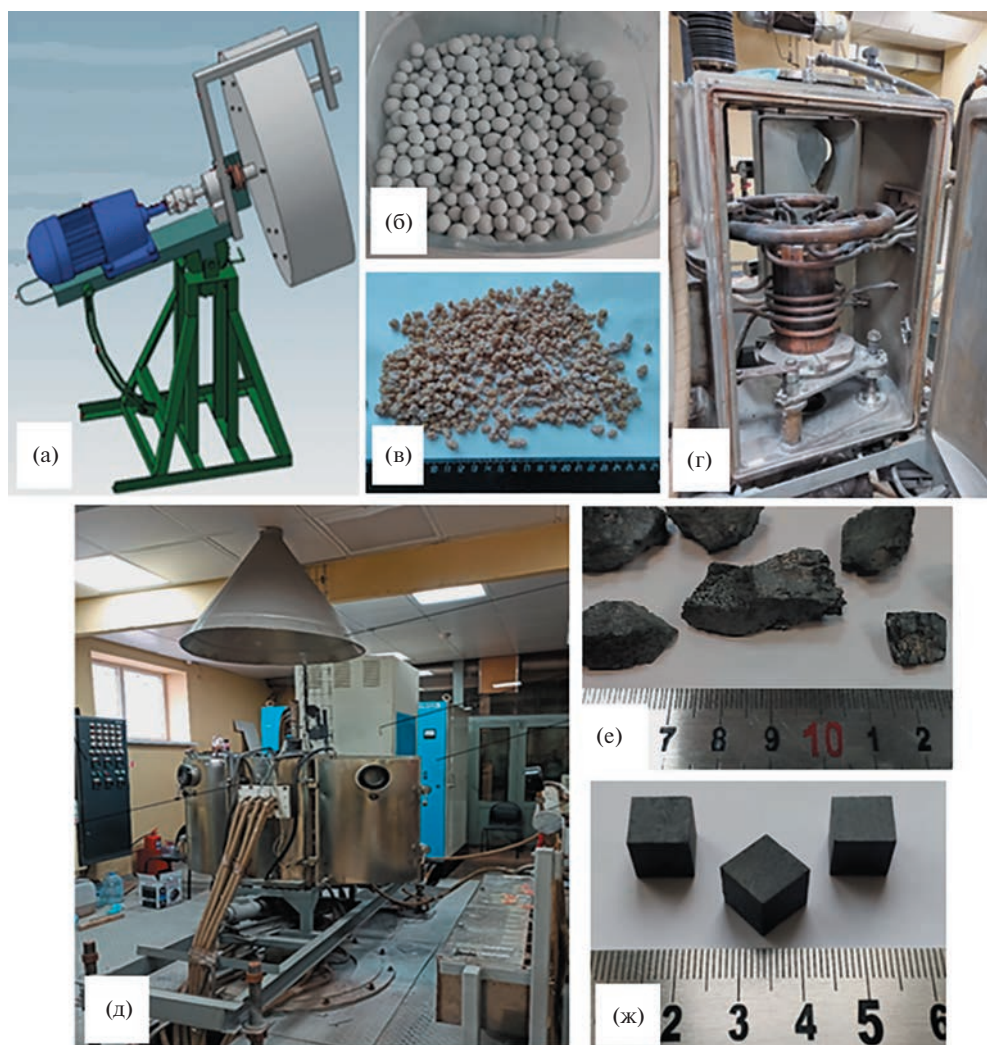
Рис. 1. Установка для грануляции (а). Гранулы исходной шихты образцов “П” (б) и “РТ” (в). “Холодный” тигель (г) и установка ИПХТ (д). Подготовленные для изучения образцы (е, ж).
