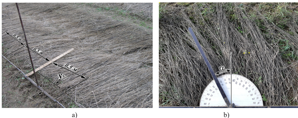
Р и с. 2. Измерение: а) – ординат комлевой части ленты относительно базовой линии; б) – ординат углов перекоса стеблей в ленте
