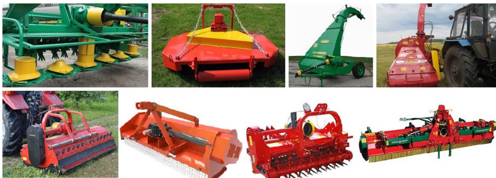
Р и с. 1. Косилки-измельчители, плющилки и мульчировщики слева направо верхний ряд: КДП-310; КРС-1,4; роторная КИР-1,85М; КИН-Ф-1500; слева направо нижний ряд: с цеповым аппаратом MU-LW; молотковая; SEPPi SMO pick-up; MasterCut
