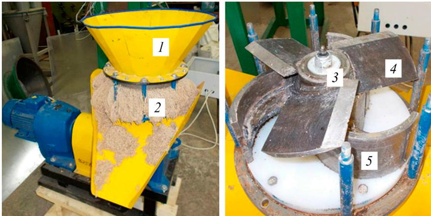
Р и с. 1. Корзинный гранулятор конструкции
