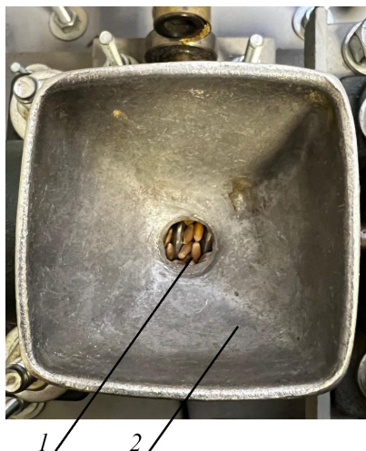
Р и с. 9. Ориентирование зерна ячменя в подающем шнеке: 1 – правильная ориентация; 2 – наклонная поверхность загрузочного бункера
