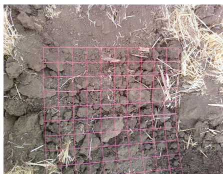
Р и с. 2. Определение глыбистости в горизонте 20–30 см после прохода глубокорыхлителя без прутков
