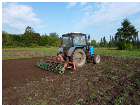
Р и с. 3. Культивация агрегатом МТЗ-82.1+Kombi-3
