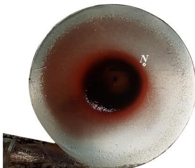
Р и с. 2. Визуализация проявления акустико-кавитационных процессов от конкурентных сливающихся потоков методом пленок F i g. 2. Visualization of the manifestation of acoustic-cavitation processes from competitive merging flows using the film method
