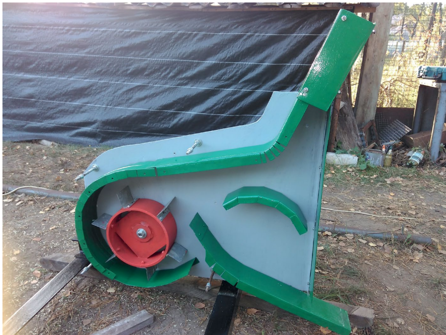
Р и с. 2. Экспериментальное устройство (боковая стенка вместе с загрузочным устройством демонтированы)
