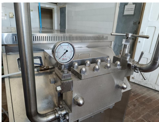
Р и с. 2. Гомогенизатор. Рабочая зона, манометр контроля давления F i g. 2. The homogenizer. Working area, pressure monitoring gauge
