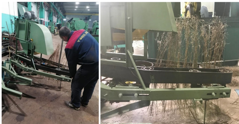
Р и с. 6. Установка стеблей льна-долгунца для проведения эксперимента
