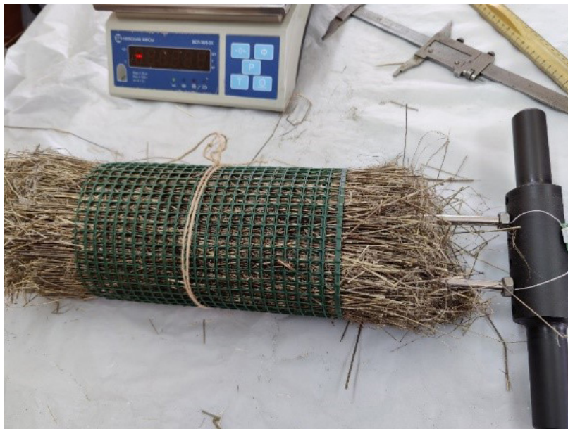
Р и с. 7. Измерение влажности стеблей
