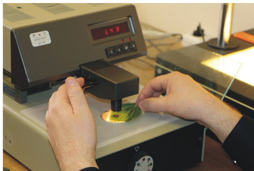
Р и с. 2. Определение оптической плотности листьев на приборе ДП-1М
