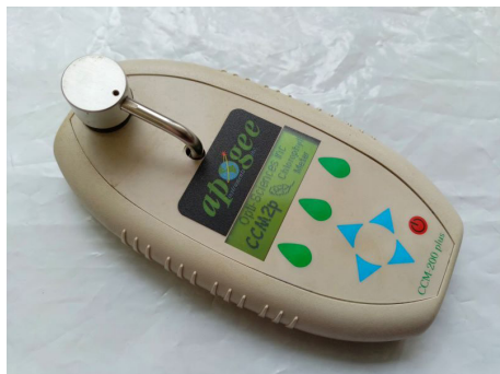
Р и с. 1. Измеритель содержания хлорофилла ССМ-200
