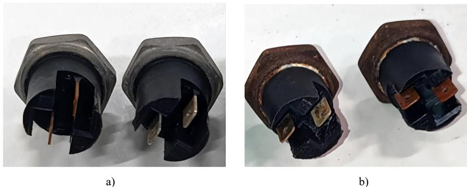
Р и с. 1. Общий вид выключателей заднего хода зерноуборочного комбайна С-исполнения с медными клеммами:
