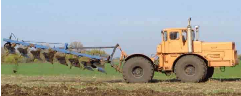
Р и с. 1. Навесной серийный плуг ПНЛ-8-40 в агрегате с трактором К-701
