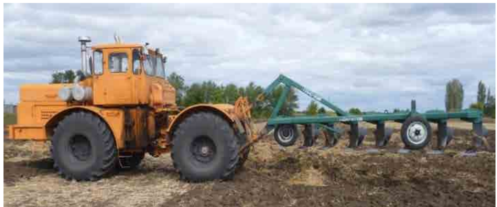
Р и с. 2. Навесной разработанный плуг ПБС-8М в агрегате с трактором К-701
