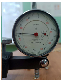
Р и с. 1. Прибор измерения толщины хлопьевидной фракции
