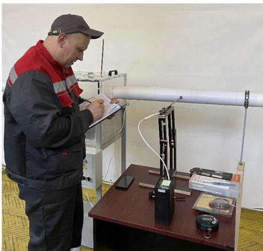
Р и с. 4. Измерение концентрации газов с помощью пробоотборного зонда и газоанализатора ЭЛАН плюс
