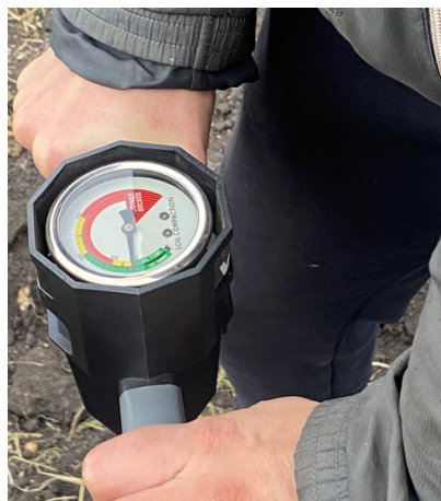
Р и с. 4. Твердомер Wile Soil F i g. 4. Hardness Tester Wile Soil
