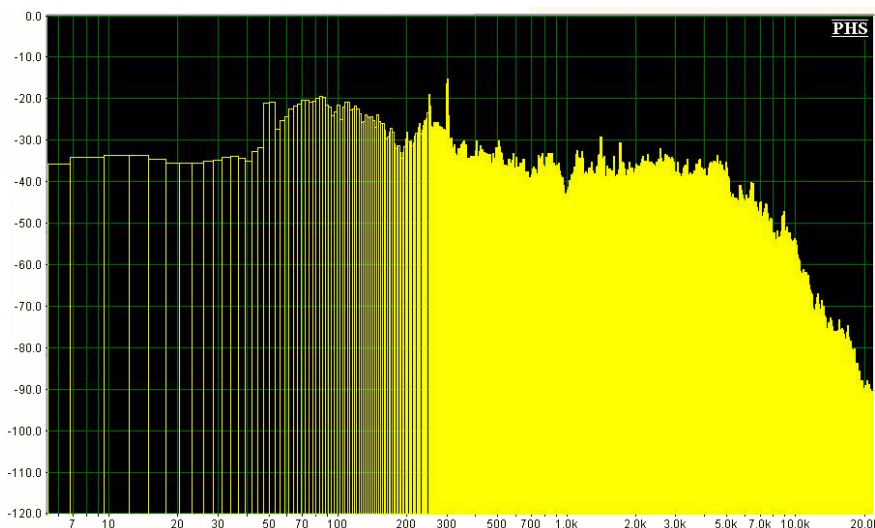
Р и с. 11. АЧХ вихревого кавитатора с насосным агрегатом
