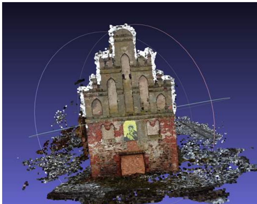
Рис. 10. Плотное облако точек кирпичи Побетен в программе-вьюере для проверки и последующего редактирования.
