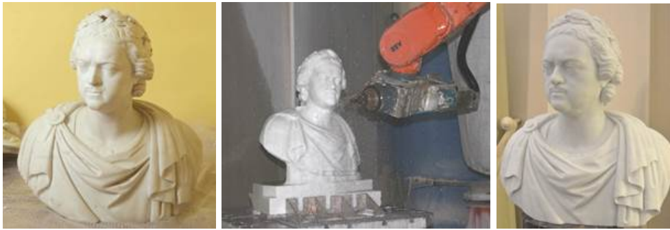
Рис. 3. Мраморный бюст Петра I: слева – оригинал; в центре – процесс изготовления копии на станке с ЧПУ; справа – готовая копия
