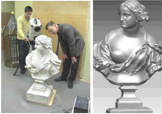
Рис. 1. Скульптура «Примавера»: слева – процесс лазерного 3D-сканирования, справа – готовая 3D-модель на экране компьютера
