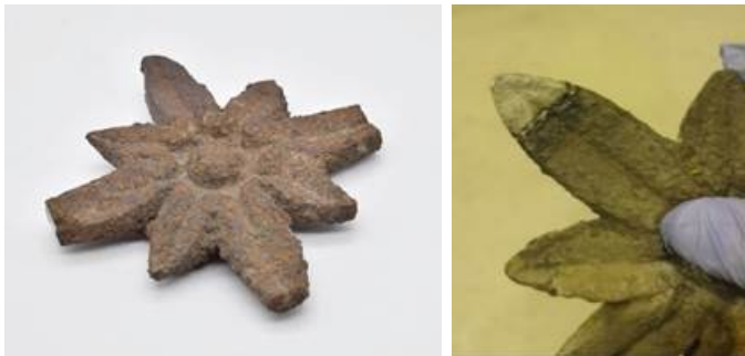
Рис. 7. Декоративный элемент чугунной ограды XIX века из Некрополя Александро-Невской лавры в Санкт-Петербурге: слева – общий вид, справа – реконструкция одного из утраченных кончиков «звезды» в результате применения лазерной наплавки
