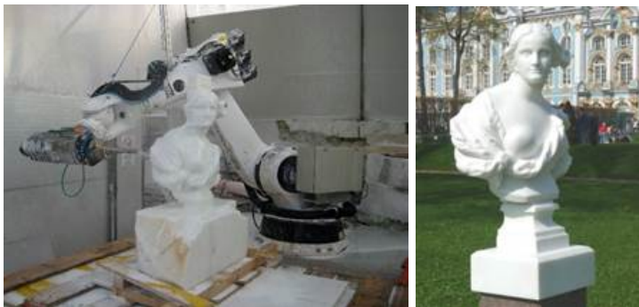
Рис.2. Скульптура «Примавера»: слева – процесс изготовления копии на станке с ЧПУ (октябрь 2009 г.); справа – готовая копия (июль 2010 г.)
