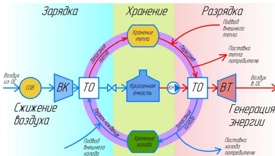
Рис. 1. Схема устройства криогенного аккумулятора энергии [21]
