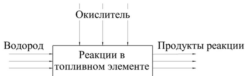
Рис. 1. Схема функционирования твёрдооксидного топливного элемента
