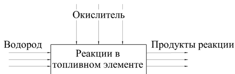
Рис. 1. Схема функционирования твёрдооксидного топливного элемента
