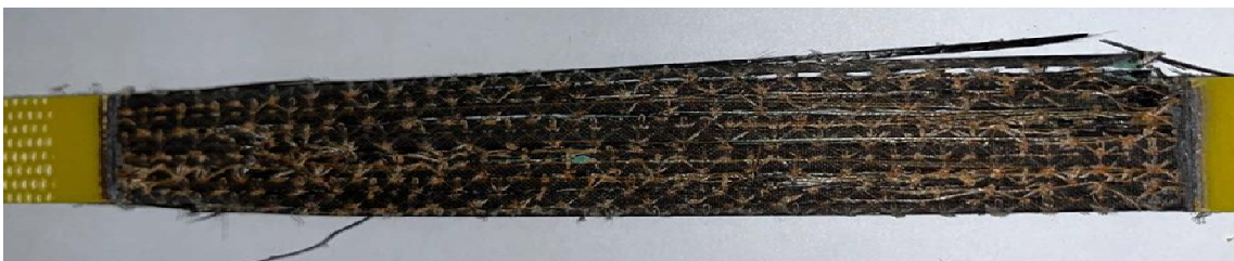
Рис. 13. Характер поведения материала при разрушении: a – образец с низким содержанием металла; б – образец с высоким содержанием металла
