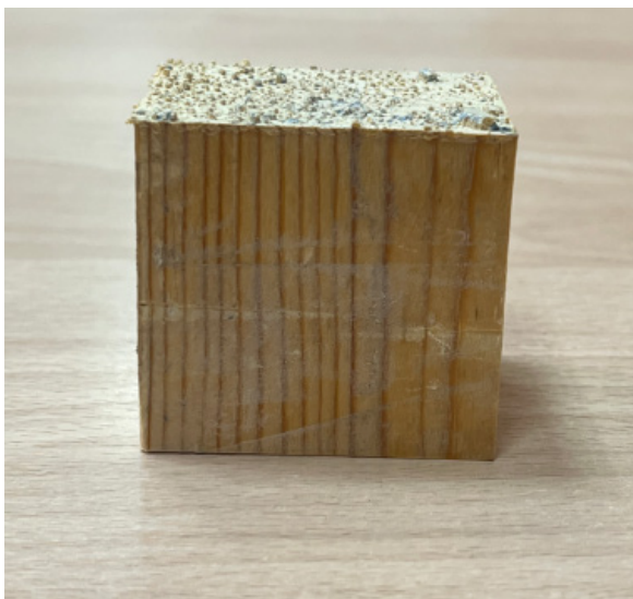
Рис. 2. Образцы термизированной лиственницы после испытания на сжатие Fig. 2. Samples of thermalized larch after compression testing
