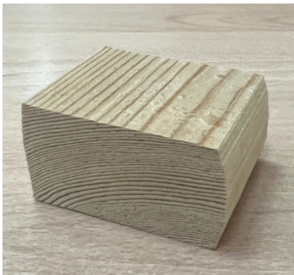
Рис. 2. Образцы термизированной лиственницы после испытания на сжатие Fig. 2. Samples of thermalized larch after compression testing
