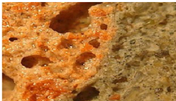
Рис. 2. Состояние контактной зоны «гранула заполнителя – цементно-песчаный камень» после 50 циклов «увлажнение–высушивание»
