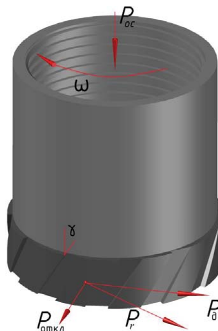
Рис. 5. Разработанная конструкция алмазного породоразрушающего инструмента: P_{ос} – осевая нагрузка на инструмент, Н; P_d – дезориентирующее усилие, Н; P_{откл} – отклоняющее усилие, Н; P_r – результирующее усилие, Н Fig. 5. Developed design of a diamond rock-breaking tool; P_{ос} – axial load on the tool, N; P_d – disorienting force, N; P_{откл} – deflecting force, N; P_r – resultant force, N
