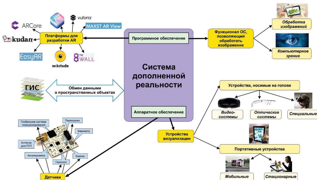
Рис. 1. Структура аппаратно-программного комплекса системы дополненной реальности в картографии и геоинформатике
