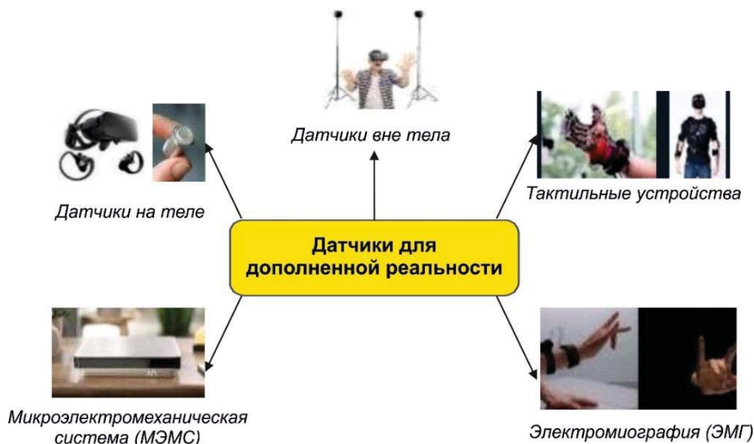
Рис. 2. Датчики для реализации функций иммерсивной реальности Fig. 2. Sensors for implementing immersive reality functions
