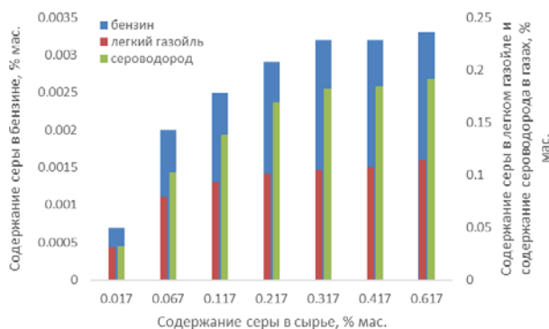
Рис. 5. Зависимость содержания серы в продуктах крекинга от содержания серы в сырье процесса (расчеты по модели)
