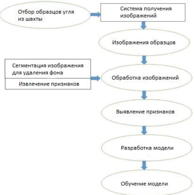
Рис. 3. Методология системы Fig. 3. System methodology
