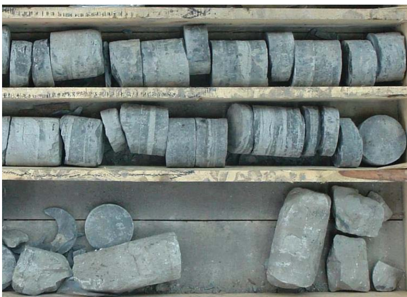
Рис. 6. Пример раздробленных образцов керна для анализа Fig. 6. Example of crushed core samples for analysis
