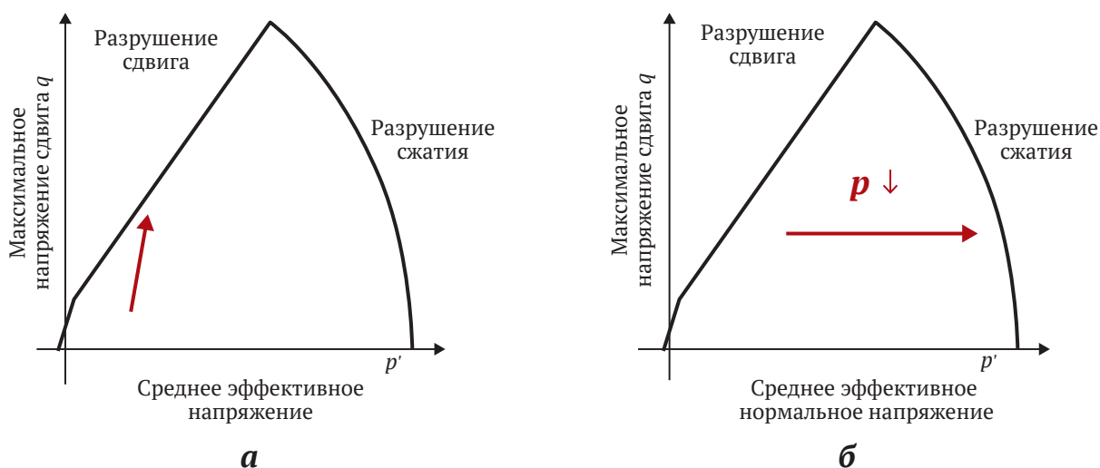
Рис. 3. Диаграммы разрушения и направление изменения эффективных напряжений в экспериментах при моделировании поля эффективных напряжений в окрестности вертикальной необсаженной скважины (а) и в экспериментах с изменением порового давления (б)
