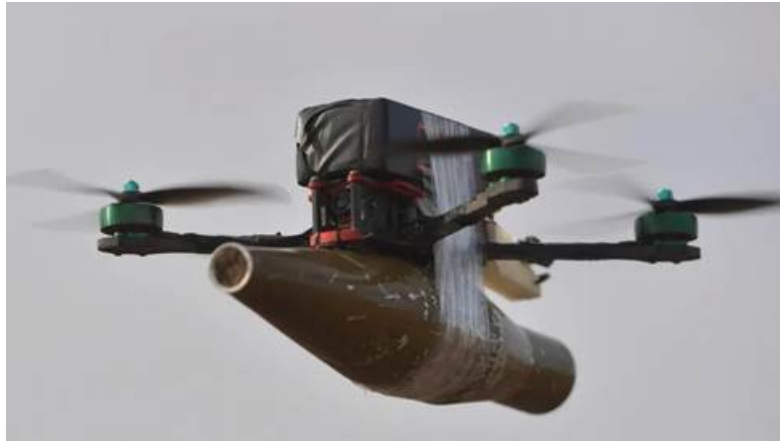
Рисунок 7. Дрон-камикадзе с гранатой от РПГ-7.
