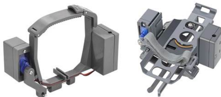
Рисунок 4. Устройства для сбрасывания груза с квадрокоптера.
