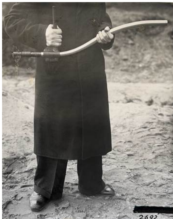
Рис. 6. 7,62-мм перископический ствол с двойным изгибом.
