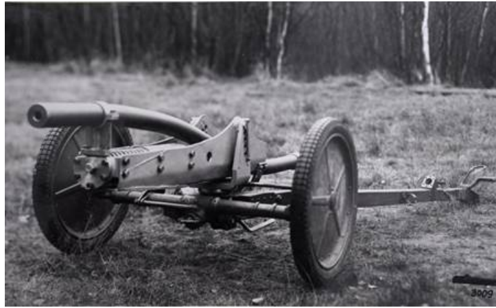
Рис. 8. Масштабный макет 25-мм полевой пушки с перископическим стволом.
