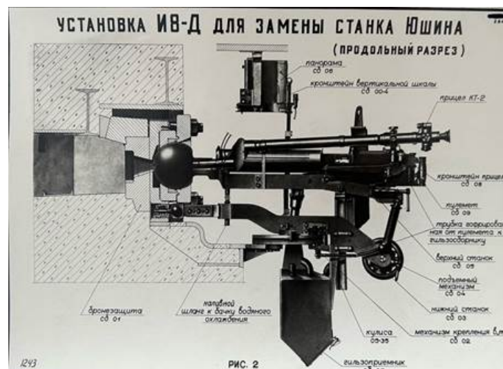
Рис. 1. Установка И-8-Д для замены станка Юшина. Продольный разрез.
