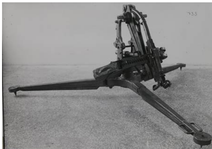
Рис. 3. Криволинейный пулемет СГМ на макетном станке УПС ОКБ-43.
