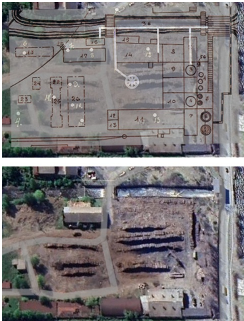
Рис. 3. Наложение фрагмента плана Баранчинского завода (ГАПК Ф. 716, Оп. 2, Д. 38) на спутниковую съемку (Google Maps). Снизу оригинальное изображение спутниковой съемки.
