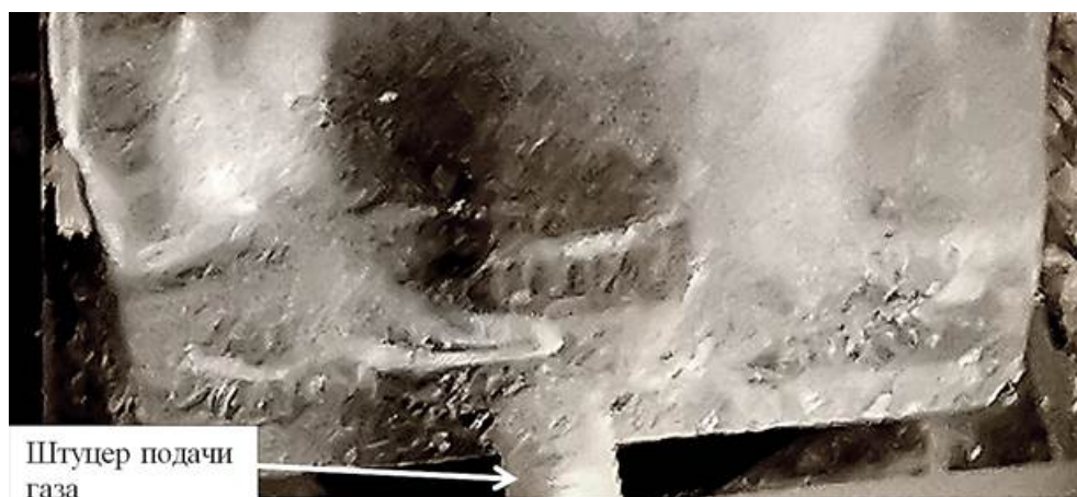
Рис. 9. Над штуцером подачи газа, во льду формируются два вида газонасыщенных зон, один в виде изгибающихся лент, другой в виде столба белого газонасыщенного льда.
