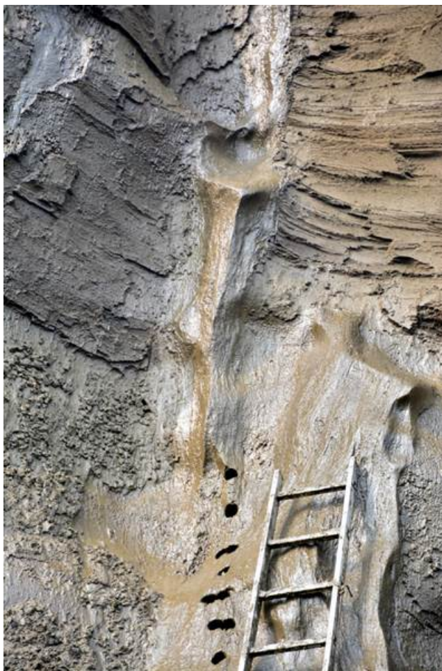
Рис. 8. Отбор образцов из композитной песчано-ледяной жилы 11 (CW-11-VV) из верхнего песка Батагайского разреза, 2019 г.
