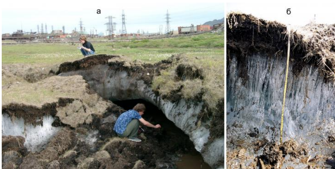
Рис. 13. Ледяное ядро (а) и структура льда (б) сезонного инъекционного бугра пучения техногенного происхождения близ г.Норильска. Фото Е. Перминовой
