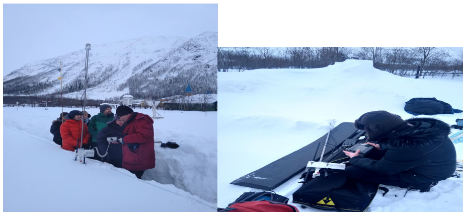
Рис. 6 внешний вид работы прибора Snow micro pen
