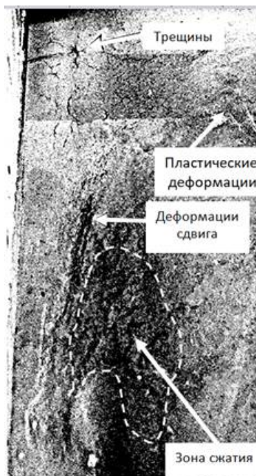
Рис. 2. Газовый мешок (в нижней части фотографии) и вызванные его формированием пластические и разрывные деформации грунта [17].
