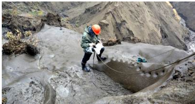
Рис. 5. Отбор образцов повторно-жильного льда IW-17 в интервале глубин 1,3-21,7 м Батагайской едомы
