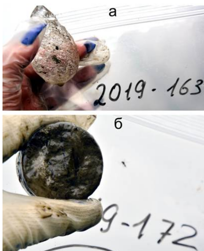
Рис. 4. Образцы повторно-жильного льда, разной степени обогащенные минеральными и органогенными примесями из IW-17 Батагайской едомы: а – чистый верхний образец №163 с глубины 1,3 м ( \text{Na}^+ – 2,57 мг/л, \text{Ca}^{2+} – 16,02, \text{Cl}^- – 3,15 мг/л); б – наиболее засоленный образец повторно-жильного льда №17 – №172 с глубины 3,1 м, сильно обогащенный минеральными и органогенными примесями ( \text{Na}^+ – 24,15 мг/л, \text{Ca}^{2+} – 53,16, \text{Cl}^- – 34,51 мг/л)
