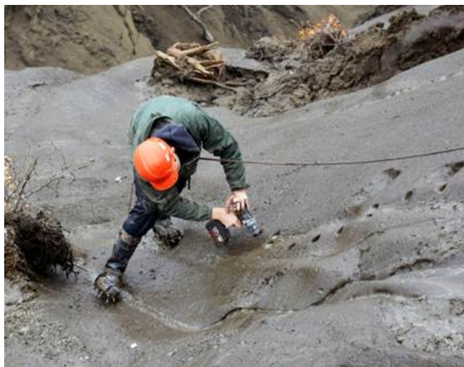
Рис. 3. Отбор образцов повторно-жильного льда с помощью электродрели из ПЖЛ IW-17 Батагайской едомы
