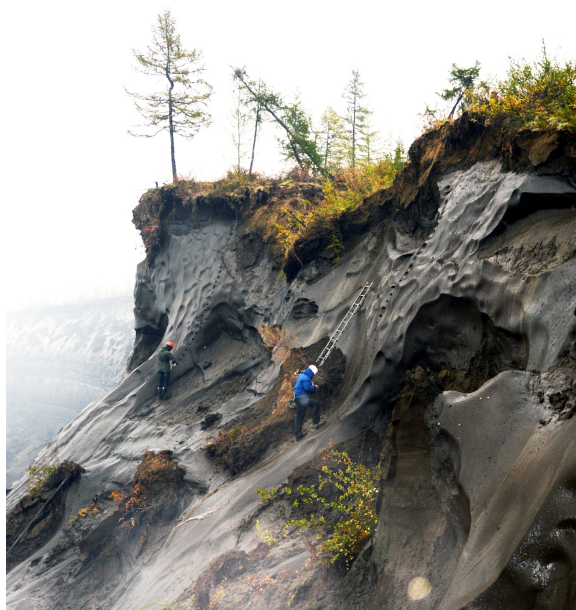
Рис. 1. Параллельный одновременный отбор образцов повторно-жильного льда из двух соседних ледяных жил IW-17 (слева) и IW-20 (справа) Батагайской едомной толщи
