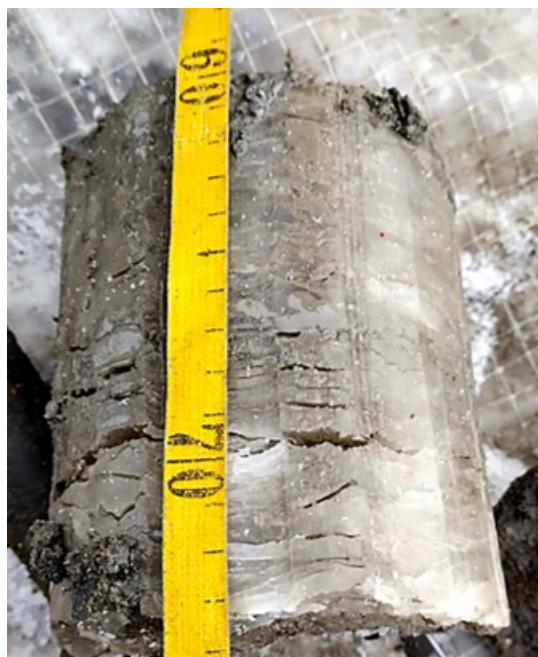
Рис. 14. Керн из льдистого горизонта (скв.5). Фотография Д.О. Сергеева.
