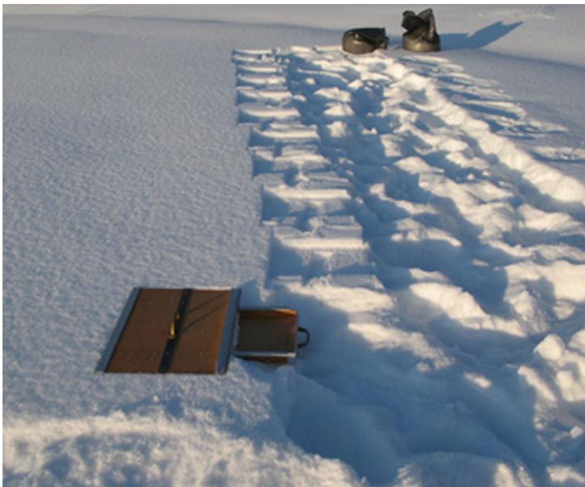
Рис. 2. Отбор проб поверхностной изморози для гидрохимического анализа (пояснение в тексте)
